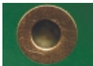
焊墊徑 2.0mm 孔徑 1.0mm
